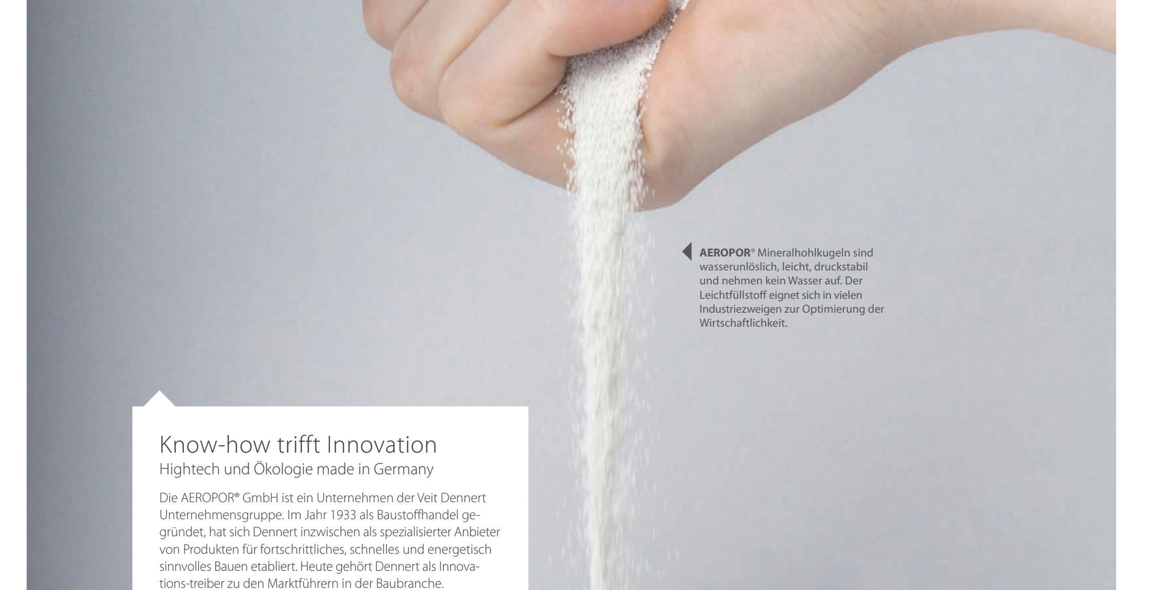
◀ **AEROPOR®** Mineralhohlkugeln sind wasserunlöslich, leicht, druckstabil und nehmen kein Wasser auf. Der Leichtfüllstoff eignet sich in vielen Industriezweigen zur Optimierung der Wirtschaftlichkeit.
